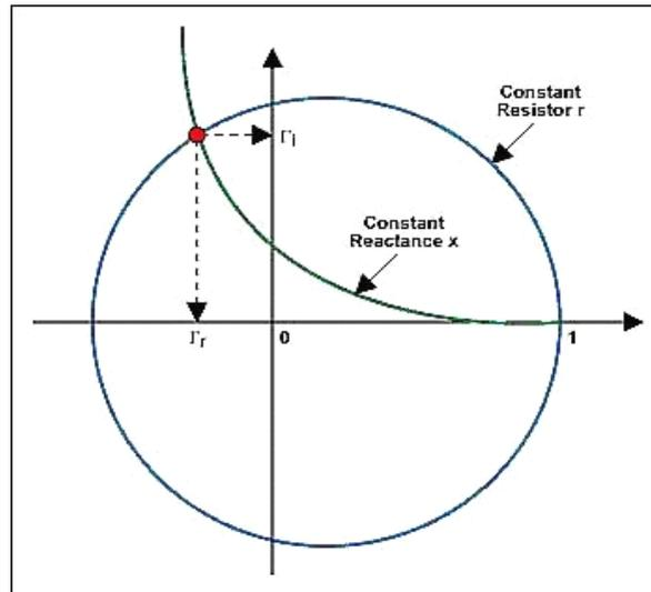
图 6. 从 X-Y 轴直接读出反射系数 $\Gamma$ 的实部和虚部
