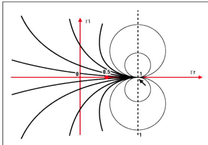
图 4b. 圆周上的点表示具有相同虚部  $x$  的阻抗。
