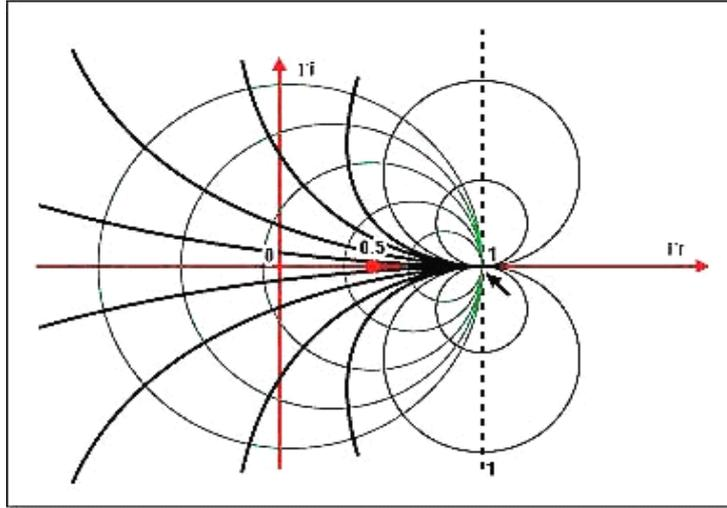
图 1. 阻抗和史密斯圆图基础
