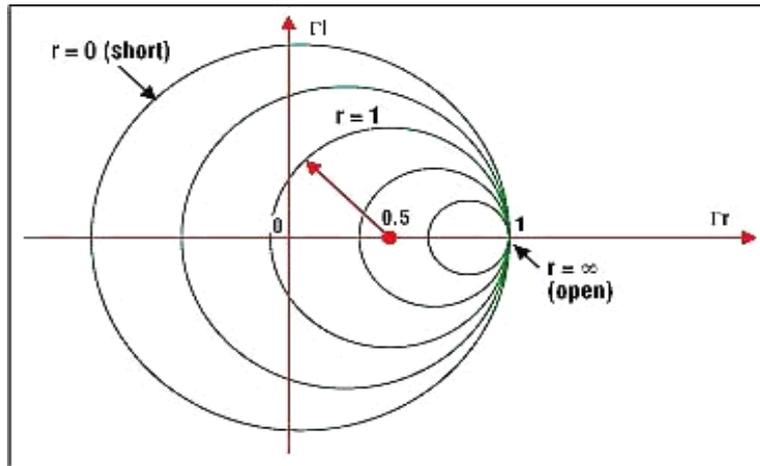
图 4a. 圆周上的点表示具有相同实部的阻抗。
